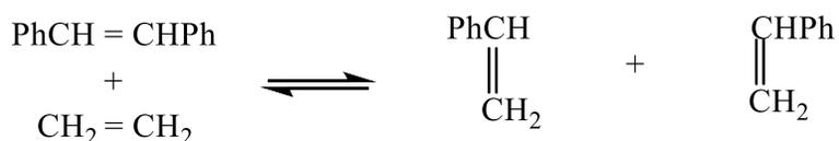
Figura 1. Reacción de metátesis de alquenos.
